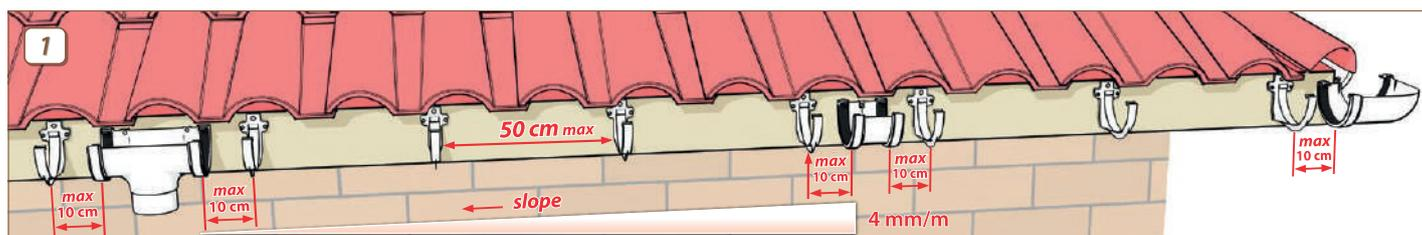
1. Installare il raccordo di scarico, considerando la posizione del pluviale e la direzione di pendenza della gronda. Utilizzando una corda in tensione, segnare l'inclinazione e installare le cicogne, iniziando dalla più lontana, verso il raccordo di scarico. La distanza tra 2 cicogne dovrebbe essere di max 50 cm. e tra una cicogna ed un altro raccordo (raccordo di scarico, giunto, curva o tappo finale), max 10 cm. Utilizzare le viti 5x30 mm (per il legno) per fissare tutti gli elementi.
