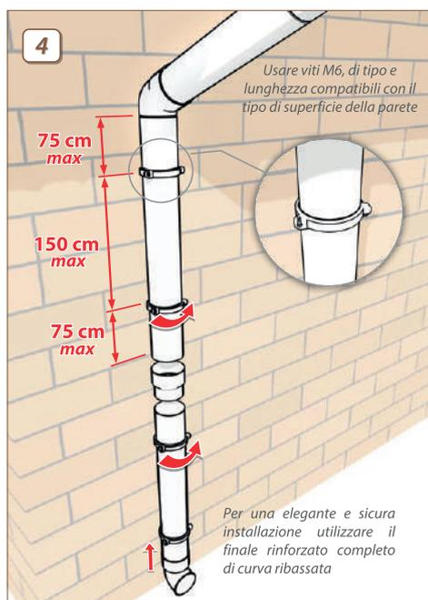
4. Installare i collari alla distanza di 150 cm tra ognuno ed al massimo di 75 cm dalla fine del pluviale. Dopo aver inserito il tubo nel collare, chiudere la fascetta e avvitare la vite di bloccaggio.
