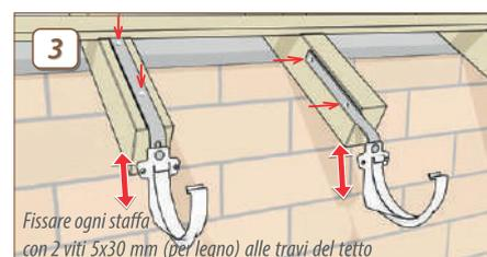
3. Per installare il sistema sulle travi, usare le staffe piatte o laterali. Usare viti e dadi M6x16 per fissare le cicogne, in modo da regolare facilmente la gronda con l'inclinazione necessaria.
