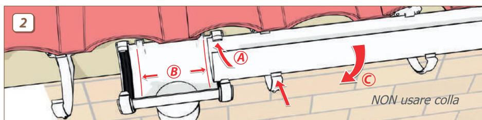
2. Per installare la gronda, prima inserire il bordo interno del profilo **A**, regolare la profondità di inserimento della gronda **B** controllando le linee indicate sul raccordo, in modo da lasciare spazio per la dilatazione termica, contrazioni, e finalmente ruotare e far scattare **C** il bordo esterno della gronda in ogni cicogna e/o elemento di connessione per un fissaggio rigido.
