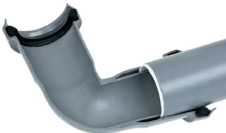
I raccordi della “**LINEA DOPPIO INNESTO**” sono brevettati. Il brevetto consiste nell’applicazione di un’anima interna al bicchiere di uscita che va ad inserirsi all’interno del tubo, creando così una doppia sicurezza.
